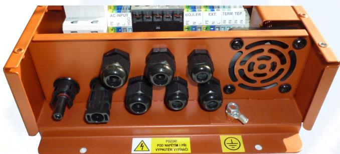
**Přístroj je možné přizemnit k vnější ochranné svorce (napravo od průchodek) vodičem o dostatečném průřezu, avšak pouze přímo na svorkovnici PE v soustavě TNS nebo PEN v soustavě TNC v hlavním rozvaděči.**
