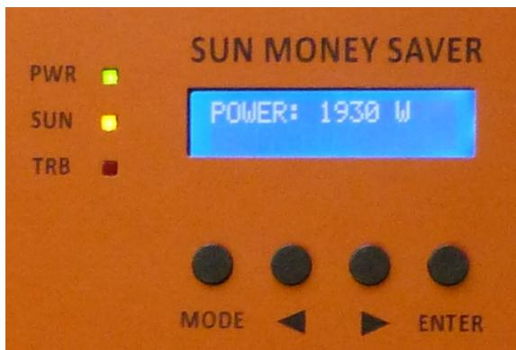
Nalevo od displeje jsou tři signalizační LED. Zelená (PWR) signalizuje, že MPPT regulátor je aktivní, žlutá (SUN) signalizuje přítomnost napětí z FV panelů a červená (TRB) varovné stavy, např. přetížení.
