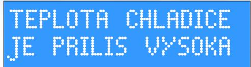
Tento stav není normální, takže pokud dojde k opakovanému přehřátí, je nutné zařízení odstavit, zkontovalit nastavení systému a pokud se zdá vše v pořádku, kontaktujte výrobce.
