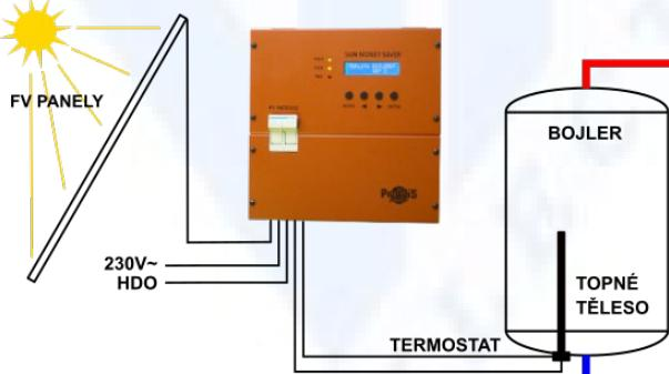
bojleru 230V/50Hz a k sériově zapojeném poli fotovoltaických panelů. Výstup pak vede přes kontakty termostatu bojleru k topnému tělesu elektrického bojleru. Alternativně lze připojit i vstup od signálu HDO, který kontroluje spínání bojleru ze sítě při nízkém tarifu.
