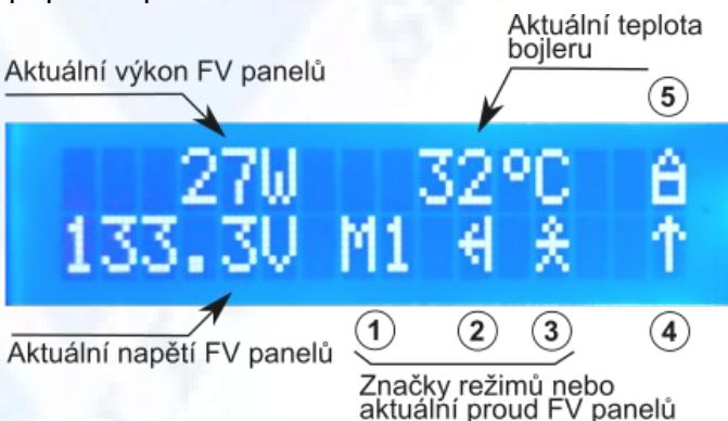
Pokud je bojler dohříván pouze z FV panelů je na pozicích 1-3 (viz obr.) zobrazen aktuální proud, v jiném režimu se zobrazují značky na pozicích:
